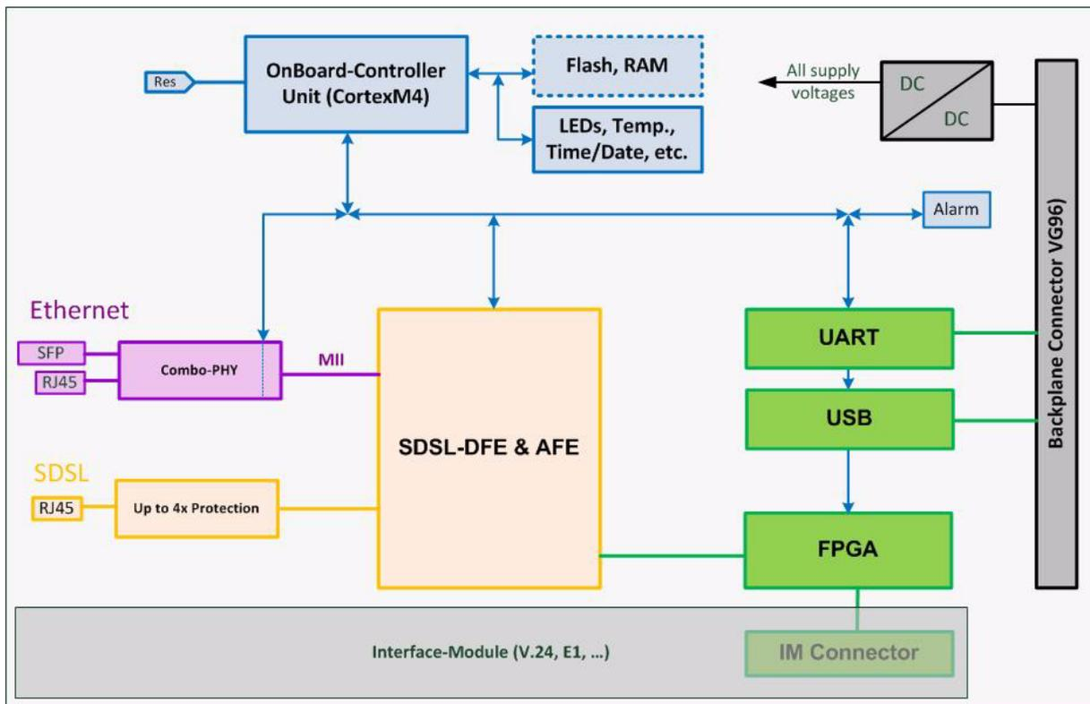
**Figure 3-1 CSX Block-Diagram**
